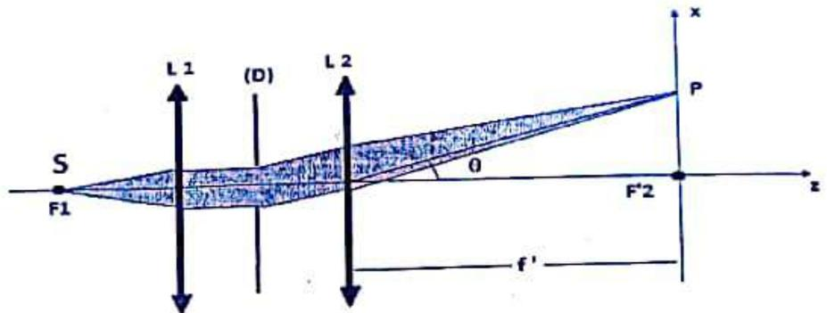
La source lumineuse S est monochromatique, ponctuelle de longueur d'onde  $\lambda = 0.630 \mu\text{m}$ . L'intensité de l'onde incidente est  $I_0 = A_0^2$  avec  $A_0$  son amplitude.
